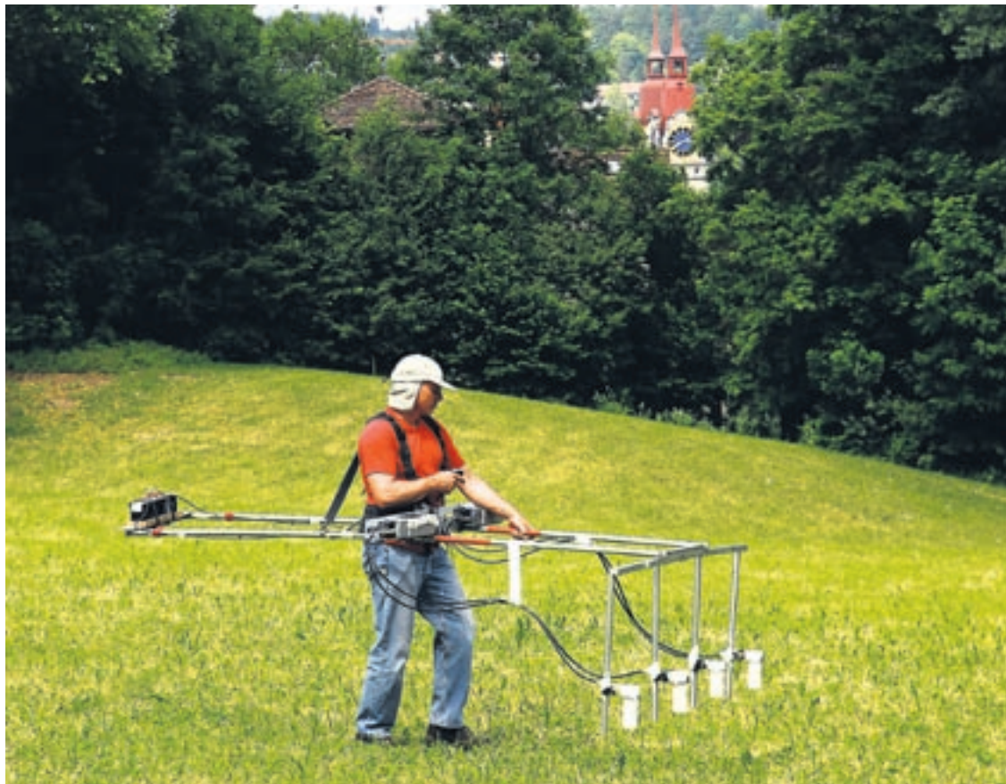
Der Cäsium-Magnetometer im Einsatz auf der Büelwiese. Rechts die Fläche, die in den nächsten Tagen geophysikalisch untersucht wird. Bild: mad/www.gis.zh.ch
